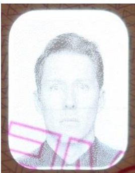
Ansiktsbilden infälld i ett tunt metallskikt i fönsterelementet
